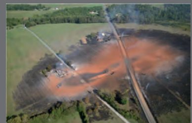
Conséquences d'une fuite sur une canalisation de transport, Appomatox (USA), 14 septembre 2008 (source pstrust.org).
